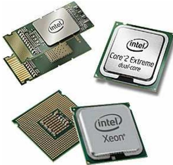
**Procesador (Micropocesador):** Microchip más importante en una computadora, es considerado el cerebro de una computadora. Está constituido por millones de transistores integrados. Este dispositivo se ubica en un zócalo especial en la placa madre y dispone de un sistema de enfriamiento (generalmente un ventilador).
